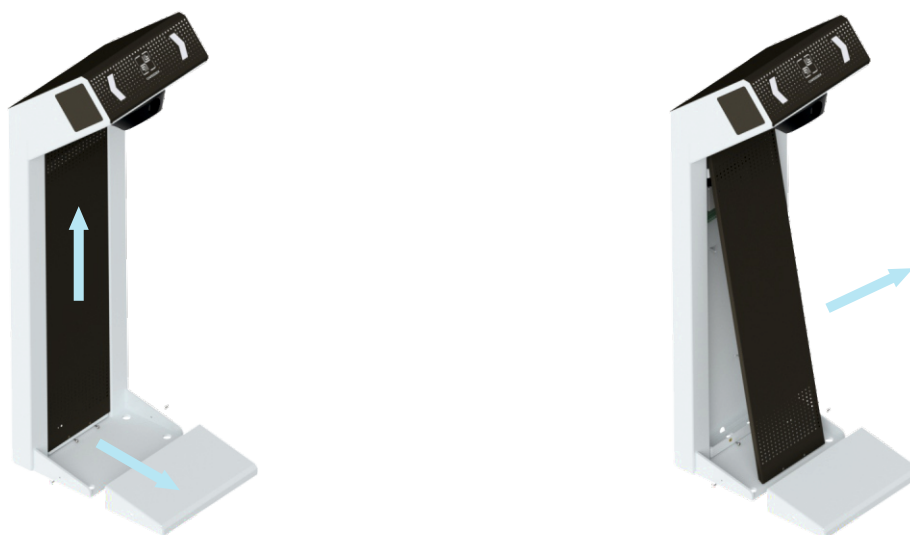
Рисунок 7.4.2 – Разборка кожухов турникета
