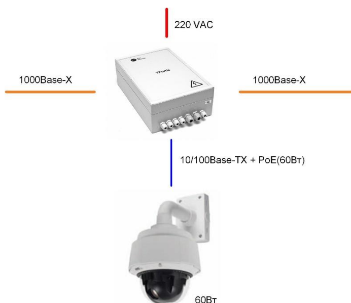
Рисунок 1.1 - Схема подключения одной камеры с потреблением 60 Вт.
